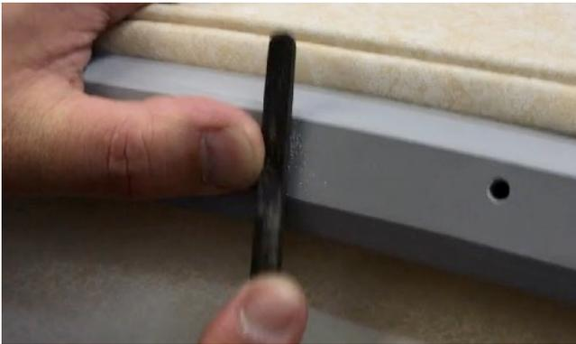
3. 折れ残った先端を、棒ヤスリで削ります。
