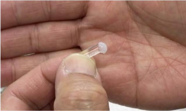
14. フックの先端（L字の長い方）に接着剤を塗布します。
