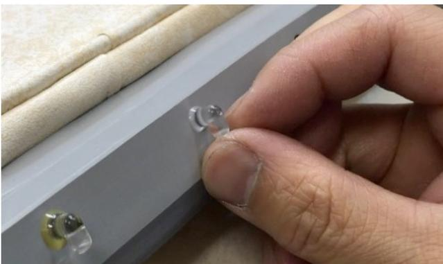
16. 挿入したら1~2回、回転させて接着剤を馴染ませ、下向きになるよう位置を調整します。
